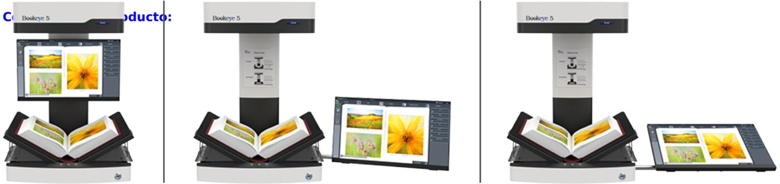
Hay **tres posiciones posibles para conectar la pantalla táctil** : conectada al cuello del escáner, conectada al costado del escáner más cerca del frente o conectada al costado del escáner más cerca de la parte posterior, donde puede inclinar el monitor en varios grados. También se puede utilizar suelto, tumbado junto al escáner. La imagen de arriba muestra las tres posiciones adjuntas.
